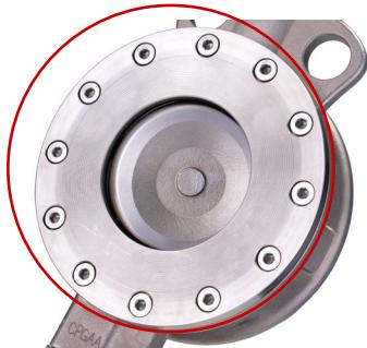
Kraftig boltet sæde-backupring der sikre sædet under tryktest og senere ved installationen. Konstruktionen giver mulighed for let sædeudskiftning.
