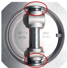
Tætningsringe som forhindrer gennemtrængning af mediet ind til bøsning samt forhindre at akslen beskadiges.
