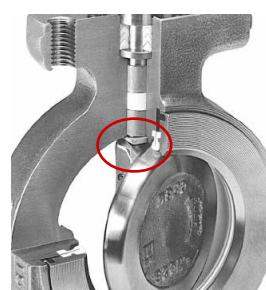
Ingen pakning mellem klap og hus. Hermed kan korrosive medier eller partikler komme i kontakt med spindel og bøsninger og dermed beskadige akslen.
