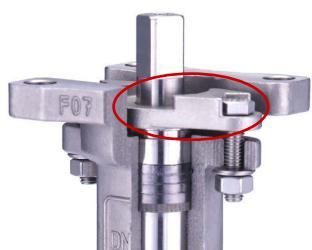
Det er nemt at efterspænde spindelpakningen, selv med en aktuator monteret. Med en konisk trykbøsnings kompenseres der for uens/skæv justering af pakbrillen.
